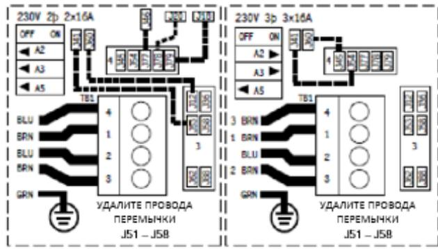
ДЛЯ ПОДКЛЮЧЕНИЯ ПИТАНИЯ ИСПОЛЬЗУЙТЕ ПРОВОДНИКИ, РАССЧИТАННЫЕ НА РАСЧЕТНЫЙ ТЕПЛОЙ ТОК 60 °С, НО С НОМИНАЛОМ НЕ МЕНЕЕ 90 °С.
